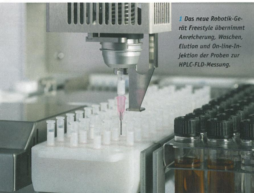
1 Das neue Robotik-Gerät Freestyle übernimmt Anreicherung, Waschen, Elution und On-line-Injektion der Proben zur HPLC-FLD-Messung.
